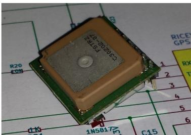
Parlando con un mio collega vengo a conoscere l'esistenza di un modulo ricevitore a basso costo che lui utilizza per la telemetria di modelli navali radiocomandati, si tratta del Fastrax UP501.
